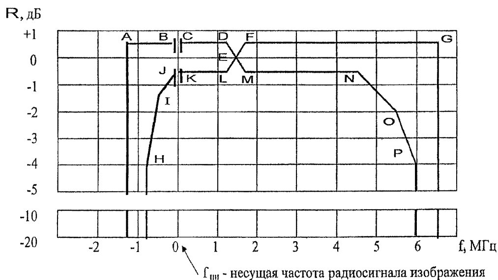
Рисунок 1. Шаблон допустимых значений АЧХ боковых полос в полосе частот от ( f минус 1,25 МГц) до ( f + 6,5 МГц)
